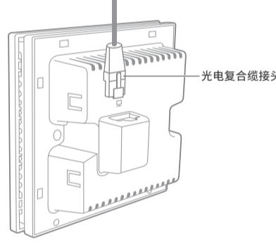
3 对准AP与暗盒上的螺丝孔，装入2个螺钉固定，请勿将螺钉拧得过紧
