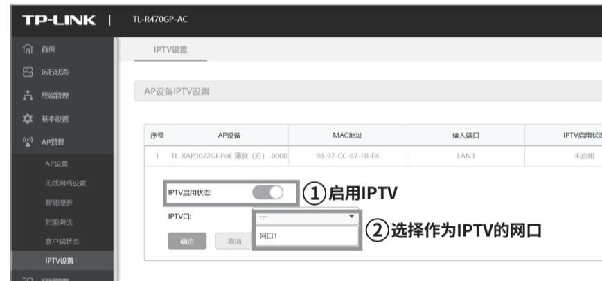
4 用网线将易展AP前面板的网线接口与电视机机顶盒的网线接口连接,根据机顶盒厂商配置说明完成IPTV配置。
